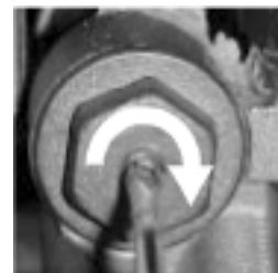
Fig. 30 Reglarea supapei de suprapresiune
